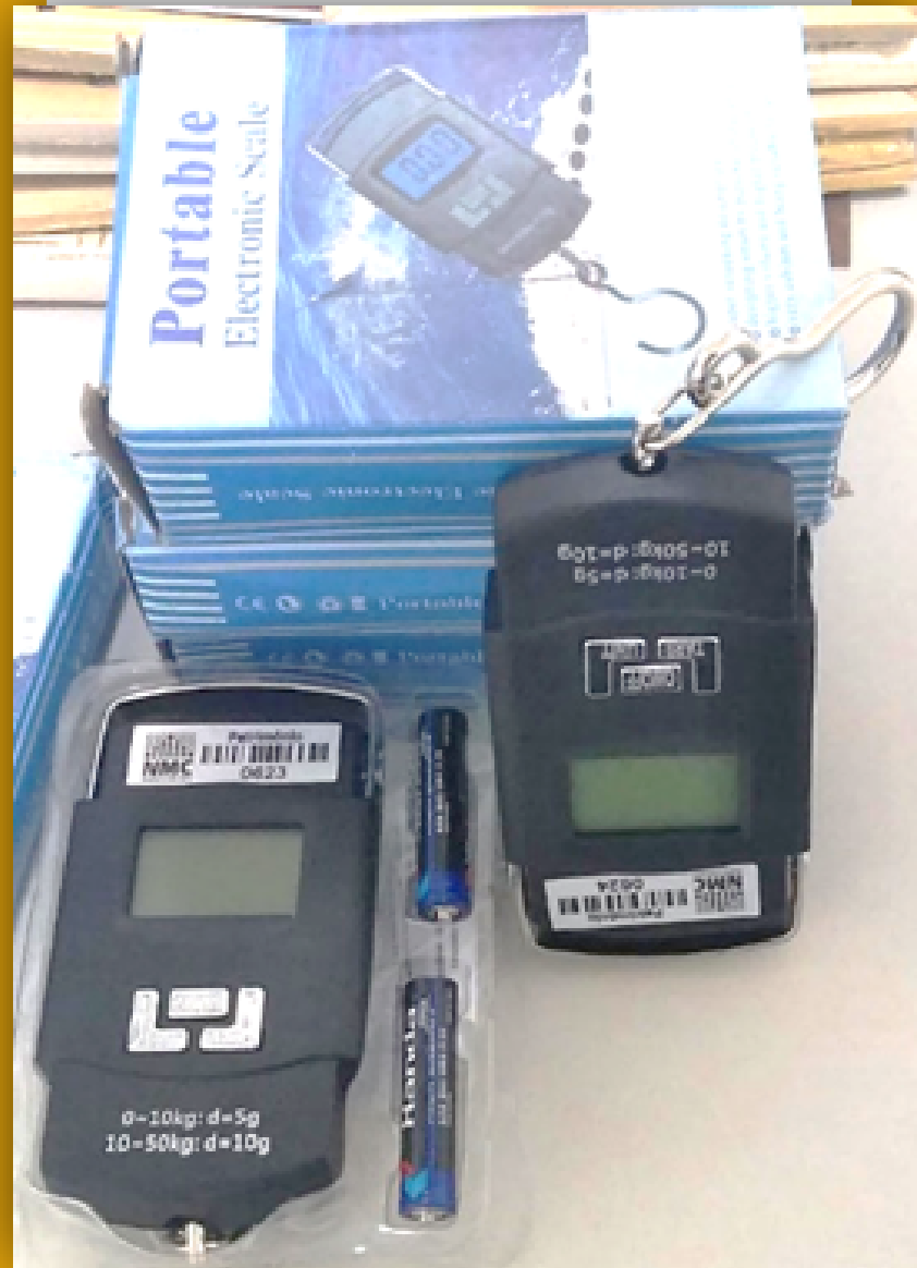
Balança para pesagem dos resíduos sólidos
